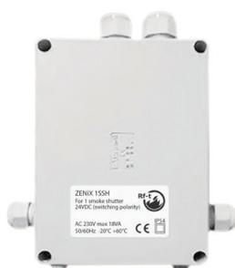
Das Feldmodul ZENiX 1SSH dient der Überwachung und Steuerung von 1 motorisierten Rauchschutzklappe mit 24 V. Der Antrieb der Klappe wird über 2 Drähte angesteuert: durch Umpolung kann die Klappe sich in die gegengesetzte Richtung bewegen. Der ZENiX 1SSH verfügt über 4 digitale Eingänge und 2 Relaisausgänge.
