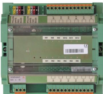
Das ZENIX DI12 Feldmodul verfügt über 12 potentialfreie digitale Eingänge. Es kann für den Anschluss zusätzlicher Alarmeingänge der Brandmeldeanlage (Matrix) verwendet werden. Das Modul kann auch für andere Eingänge verwendet werden, z. B. für den Anschluss von Endkontakten mechanischer Klappen.
