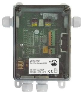
Das Feldmodul ZENiX 1FD dient zur Überwachung und Steuerung von 1 motorisierten Brandschutzklappe mit 230 V-Antrieb. Eine Konfiguration ist nicht erforderlich, da das Modul über eine vordefinierte Adresse verfügt.
